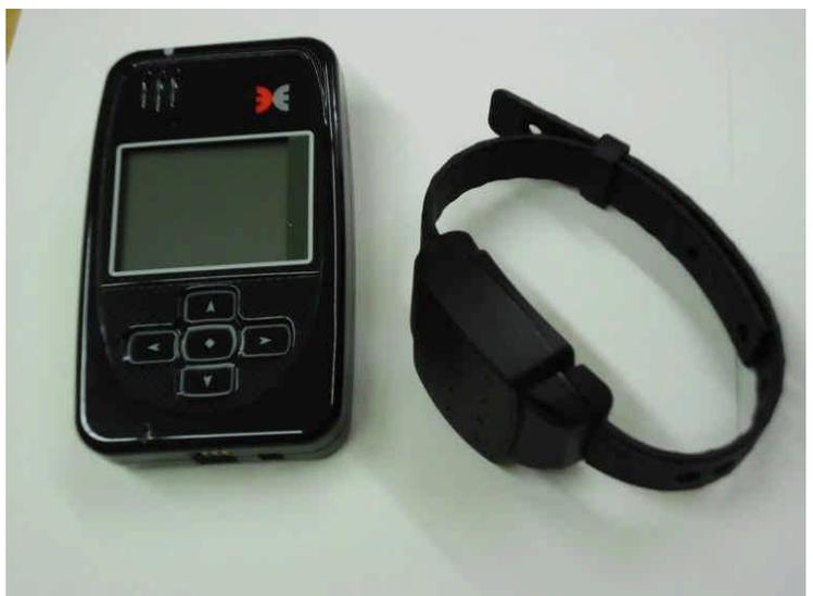
Gerät zur elektronischen Aufenthaltsüberwachung (EAÜ)
